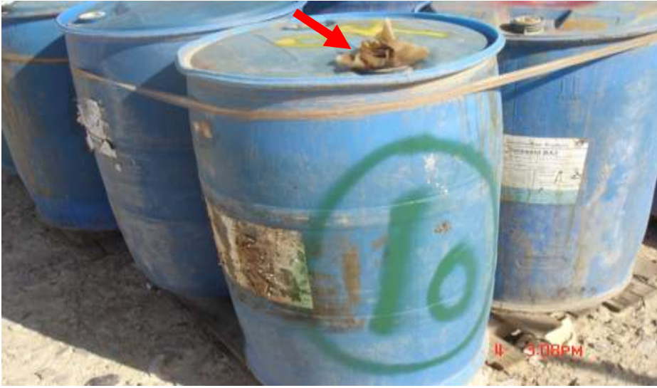
شكل (8). يوضح استخدام مخلفات قرطاسية لاغلاق فتحة البرميل (السهم) مما يسهل تسرب المادة الكيماوية أو تطايرها، بحسب نوعها.
