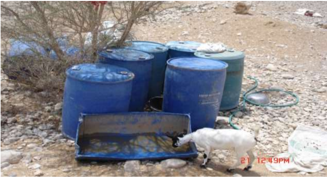
شكل (14). مثال على اهمال الاجراءات الامنية لمنع الوصول الى نفايات براميل المواد الكيميائية المستخدمة في الحفر وبالتالي انتقال التلوث الكيماوى عبر سلسلة الغذاء. شركة DNO – وادي قودة - سينون
