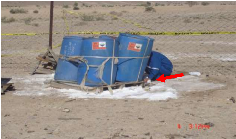
شكل (9). يوضح الاحتكاك المباشر مع المواد الكيماوية بواسطة الجلد - العامل لم يستخدم القفازات (السهم) - مما يسبب تسرب المادة الكيماوية عبر مسام الجلد الى الدورة الدموية.
